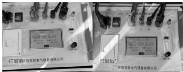
图11 打磨前后回阻示意图
