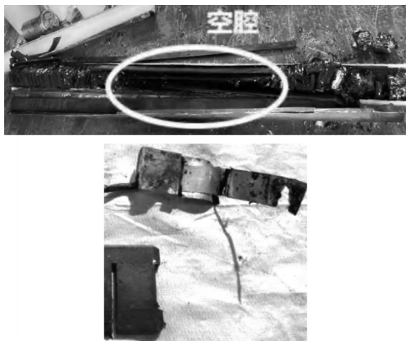
图 13 电容筒空腔及金属连接片烧蚀
