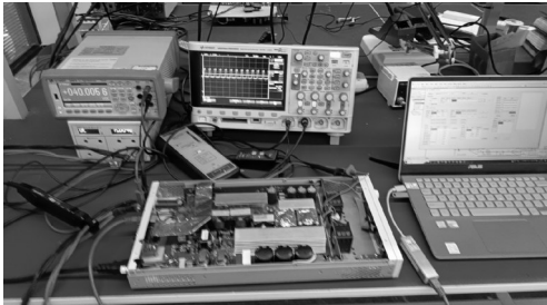
图5 改进无桥PFC样机测试平台 Fig. 5 Improved bridgeless PFC prototype test platform
