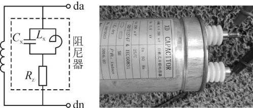
图 12 阻尼器原理及谐振电容器 Fig. 12 Dampener principle and resonant capacitor
